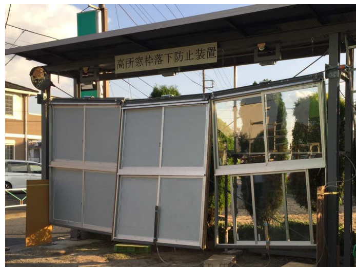
落下後(左側2枚は重さの等しい鉄板をガラスの代わりに使用)
