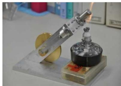
完成したエンジンに火を灯し稼働を確認
